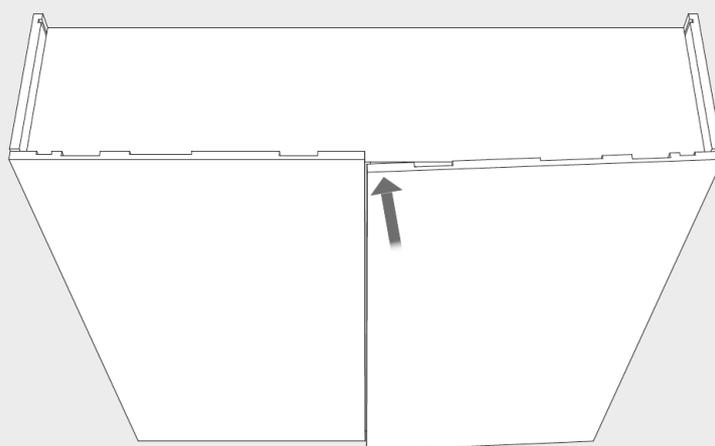
**C1** Ricontrollare le lavorazioni o la posizione dei supporti sulla parte superiore e inferiore dell'anta.
