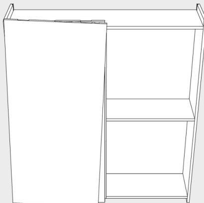
**B1** Controllare la messa in bolla dell'anta che va eseguita ad anta aperta.
