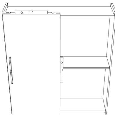
**B2** Il cielo cala sotto il peso dell'anta, inserire un montante.
